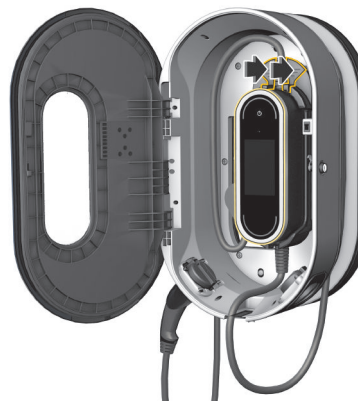
Rys. 328 Zawieszanie modułu sterowania
