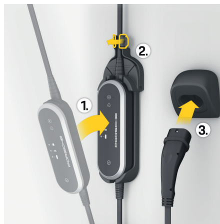
Obr. 273 Zavěšení ovládací jednotky
